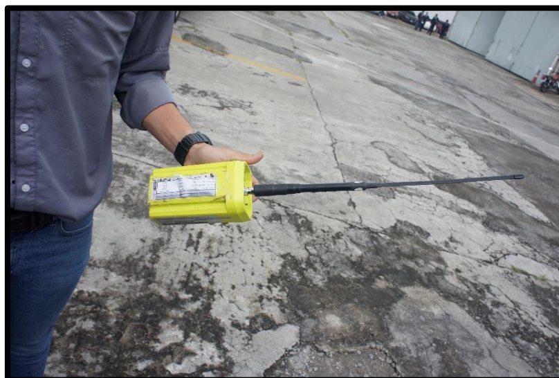
Fotografía No.: 28 Vista del ELT efectuándole pruebas operacionales.
